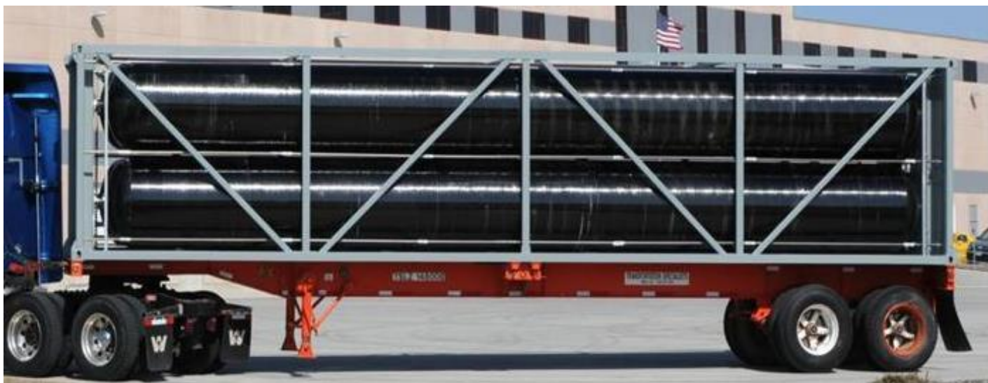
Рисунок 3. Внешний вид модуля ТИТАН4, без защитного кожуха.
